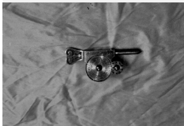
Тахометр - числовой механический прибор для измерения числа оборотов.
